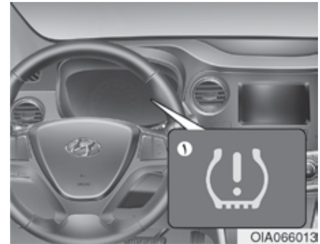
(۱) نمایشگر فشار باد لاستیک / نمایشگر ایراد TPMS
