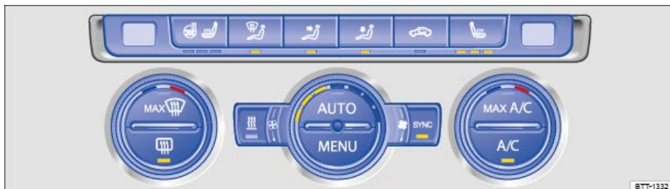
تصویر 103 در قسمت فوقانی کنسول مرکزی: اجزای کنترل تهویه مطبوع سیستم کليماترونیک.
