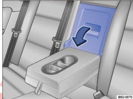
تصویر 169 در پستی صندلی عقب: باز کردن دریچه دسترسی به صندوق عقب.
