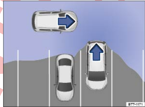
تصویر 143 نمای کلی سیستم کمکی خروج از پارک: نظارت بر محدوده اطراف خودرو در حال ترک پارکینگ.
