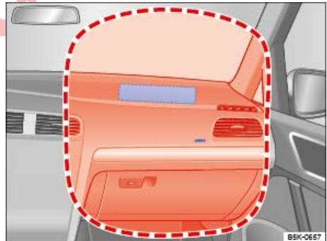
تصویر 43 محل نصب و محدوده عملکرد کیسه هوای جلوی سرنشین جلو.
