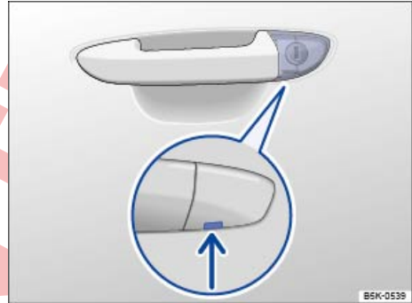
تصویر 63 دستگیره درب راننده: سیلندر مخفی قفل.
