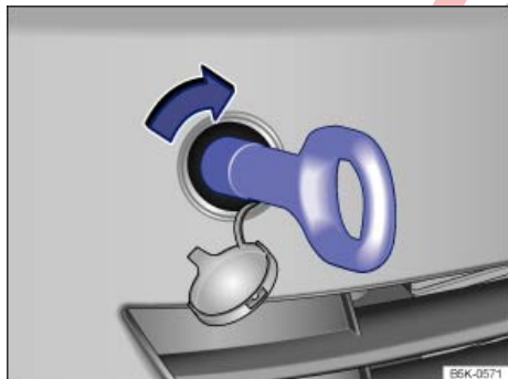
تصویر 202 در سمت راست سپر جلو: پیچ کردن و بستن حلقه بکسل.
