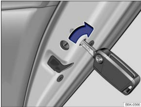
تصویر 65 روی قسمت انتهایی درب سمت راست: قفل اضطراری خودرو با کلید خودرو.
