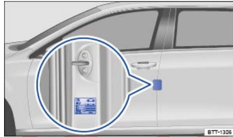
تصویر 310 در ستون درب راننده: برجیب لاستیک (یا روی قسمت داخلی دریچه باک).
