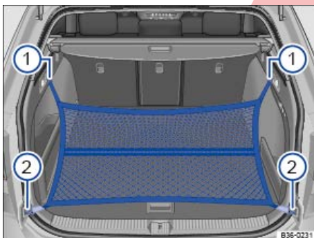
تصویر 251 در صندوق عقب: تور نگهدارنده قلاب شده در لبه بارگیری.
