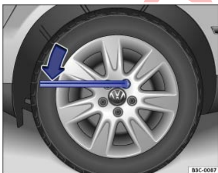
تصویر 318 تعویض چرخ: باز کردن پیچ‌های چرخ.
