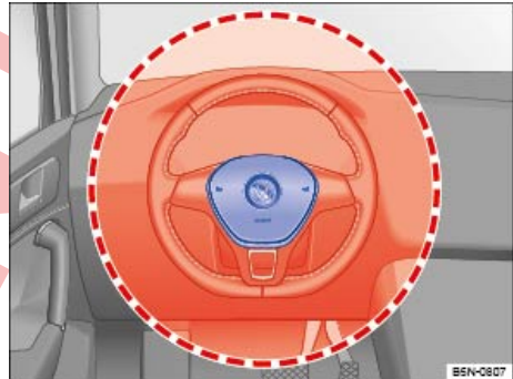
تصویر 15 محل نصب و محدوده عملکرد کیسه هوای جلوی راننده.
