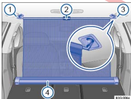
تصویر 243 در صندوق عقب: تور جدا کننده وقتی نصب می‌شود که پایه‌های صندلی عقب به سمت جلو خم شده باشند.
