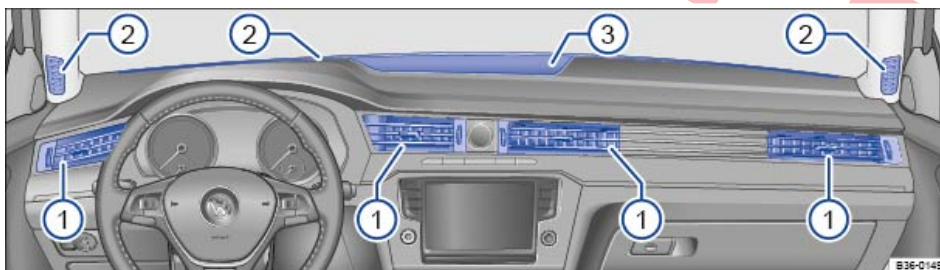
تصویر 135 در پنل داشبورد: دریچه‌های هوا.
