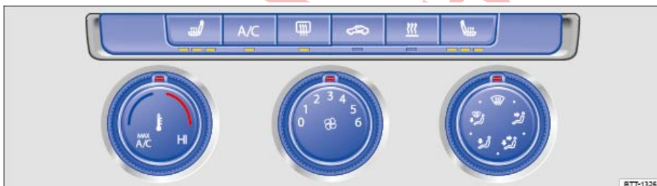
تصویر 132 در قسمت فوقانی کنسول مرکزی: کنترل‌های سیستم دمستی تهویه مطبوع یا سیستم گرمایش و هوای تازه.
