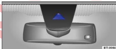
تصویر 178 شیشه جلو: دریچه دوربین سامانه دستیار حرکت بین خطوط.
