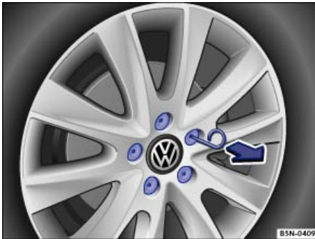
تصویر 317 باز کردن درپوش پیچ‌های چرخ.
