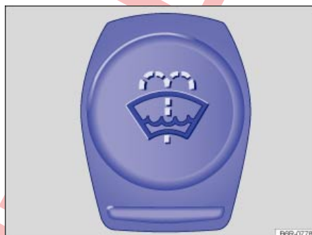
تصویر 298 درون محفظه موتور: درب مخزن شیشه‌شوی.
