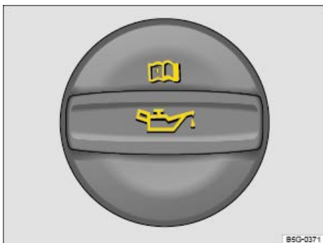
تصویر 300 در محفظه موتور: درب فیلتر روغن موتور (تصویر اصل).
