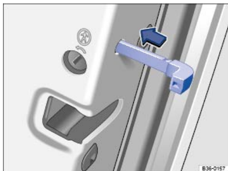
تصویر 87 روی قسمت انتهایی درب سمت راست: قفل کردن اضطراری خودرو با کلید پدکی.
