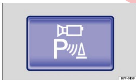
تصویر 187 در قسمت فوقانی کنسول وسط: دکمه برای خاموش و روشن کردن دستیار پارک اتوماتیک (بسته به تجهیزات خودرو).
