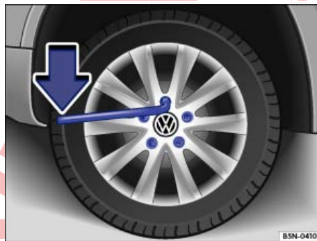
تصویر 280 تعویض چرخ: باز کردن پیچ‌های چرخ.
