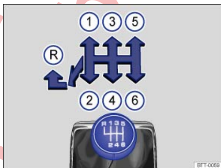
تصویر 136 الگوی تعویض دنده در گیربکس 6 دنده‌ای.
