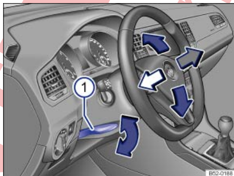
تصویر 87 زیر غریبلیک فرمان در پوشش میله فرمان: اهرم تنظیم مکانیکی موقعیت غریبلیک فرمان.
