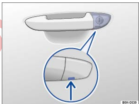
تصویر 75 دستگیره درب راننده: سیلندر مخفی قفل.
