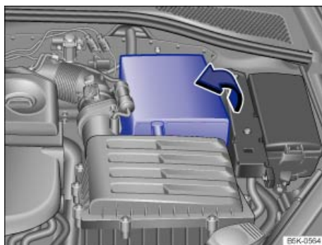
تصویر 268 در محفظه موتور: پوشش باتری را باز کنید.
