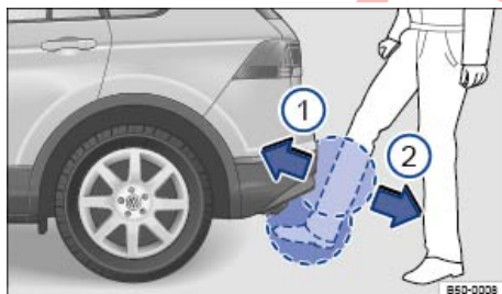
تصویر 82 باز کردن درب صندوق عقب با کنترل دارای سنسور (Easy Open).
